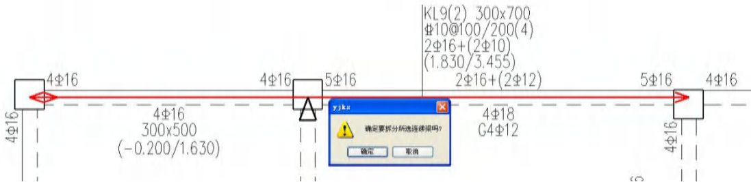
图 4.1.6-1 连续梁拆分图
